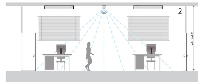
**2)** Se il sensore rileva un movimento, l'illuminazione UV si spegnerà automaticamente (ed anche il LED rosso di segnalazione).
