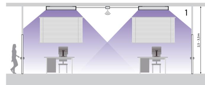
**1)** Con l'alimentazione accesa, quando il sensore non rileva nessuna presenza, dopo 60 secondi, l'apparecchio attiverà la sorgente UV e contemporaneamente si accenderà un LED di segnalazione (rosso).
